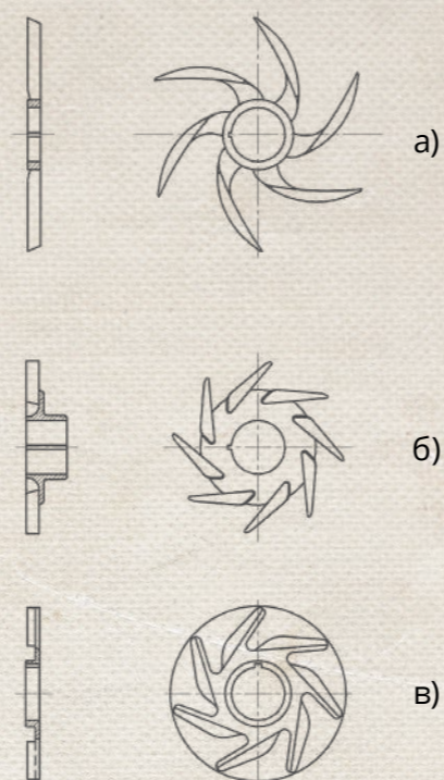
Рис. 10. Различные конструкции открытых рабочих колес
