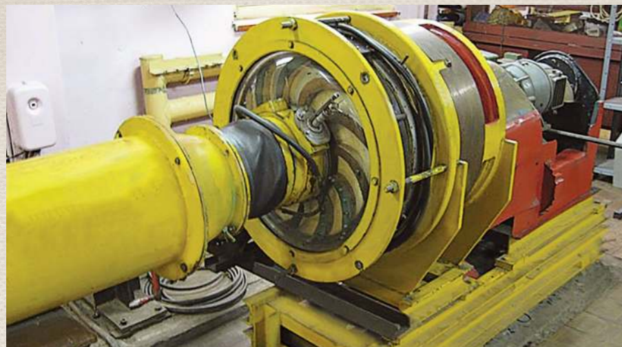
Рис. 15. Аэростенд для исследования структуры потока в ступенях
