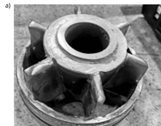
Рис. 1. Внешний вид рабочих органов, подверженных гидроабразивному износу: а – входная решетка; б – защитная гильза
