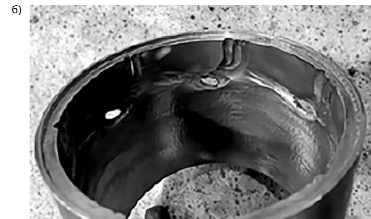
Рис. 1. Внешний вид рабочих органов, подверженных гидроабразивному износу: а – входная решетка; б – защитная гильза
