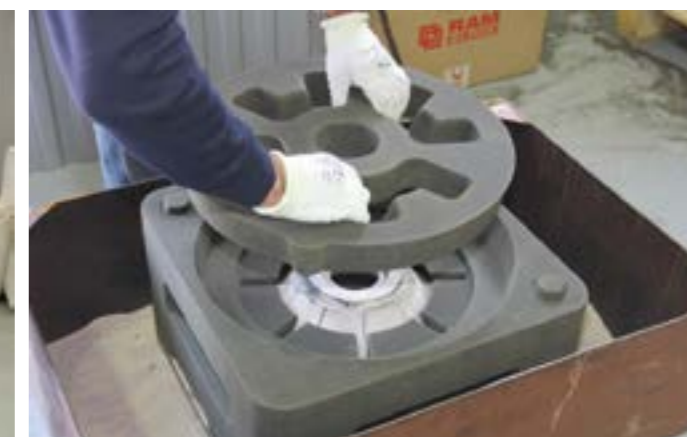
Форма под заливку ступени 16 габарита
