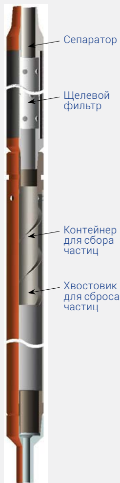
Рис. 9. Фильтр скважинный гравитационно-щелевой
