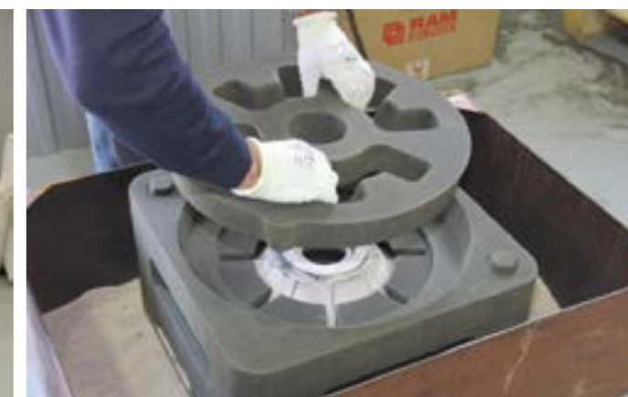
Форма под заливку ступени 16 габарита
