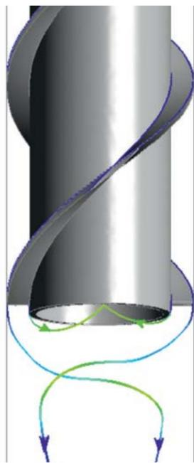
Рис. 6. Траектории частиц в нижней части гидроциклонного сепаратора
