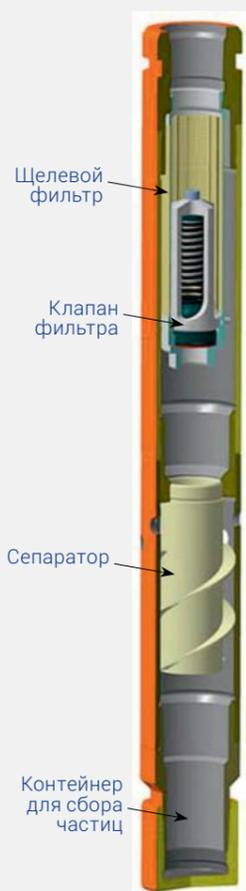
Рис. 10. Фильтр скважинный каскадный
