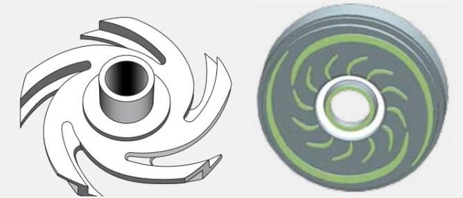
Рис. 3. Конструкция ступени ЭЦНО5-20
