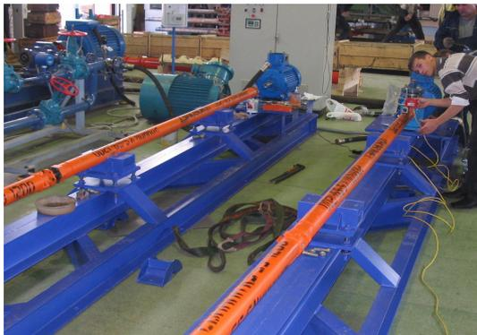
Рис.8. Юстировка и испытания насосных установок в цехе сборочного производства
