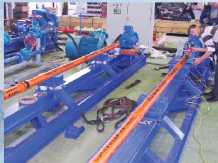
Центровка и испытание насосных установок в цехе сборочного производства
