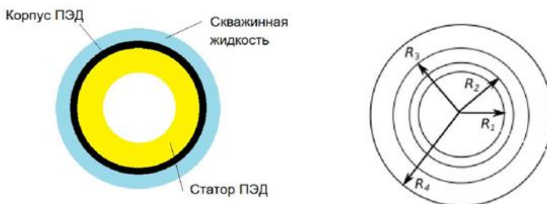
Рис. 3. Методика быстрого расчета средней температуры изоляции Слева – расчетная область, справа – модель магнитопровода статора
