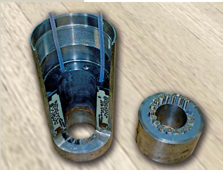
Рис. 1. Внешний вид компаундированной обмотки статора ПЭД
