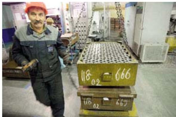
Будущие ступени — основные рабочие органы погружного насоса — перемещаются из порошкового цеха в цех механической обработки
